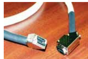
اتصال کانکتور MRJ21 به کانکتور RJ21
